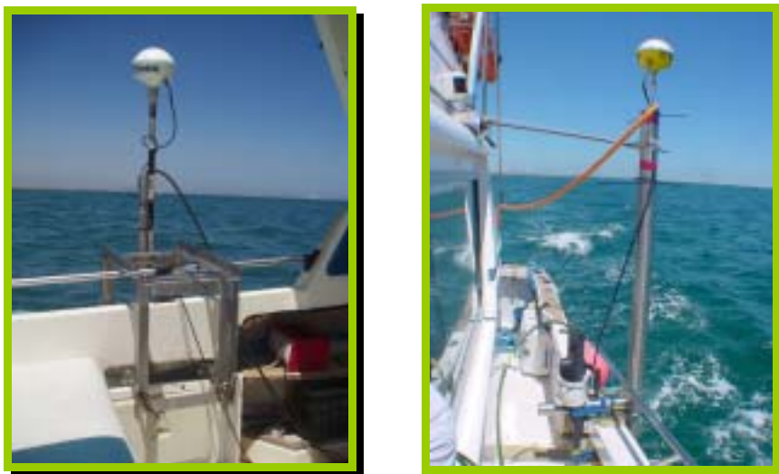
Vista en alzado del eje del transductor y del GPS diferencial
