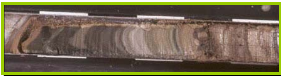
Imagen de las columnas de sedimentos (testigos) extraídas del lecho de un embalse
